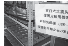
支援いただいた戸別受信機は、全数アルコールによる清掃・消毒を実施後、通電・受信確認試験、局データ入力を実施しました
