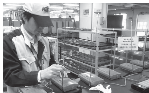
支援いただいた戸別受信機は、全数アルコールによる清掃・消毒を実施後、通電・受信確認試験、局データ入力を実施しました
