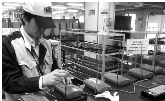
支援いただいた戸別受信機は、全数アルコールによる清掃・消毒を実施後、通電・受信確認試験、局データ入力を実施しました
